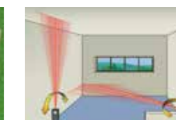
FUNÇÃO DE REMODELAÇÃO DE DISTÂNCIAS CONSTANTES: distância mínima ou máxima por medição
